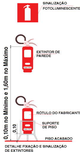
Figura 1 – Fixação de extintor
